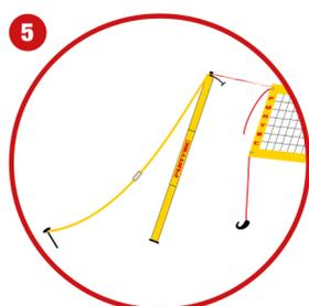
**4** Insgesamt erhältst du so vier Verankerungspunkte für die Erdnägel. Diese werden mit einem Hammer in einem Winkel (vom Pfosten weg) in den Sand geschlagen. Achte darauf, dass du vorher die Schlaufen der Spanngurte um die Erdnägelköpfe gelegt hast.
