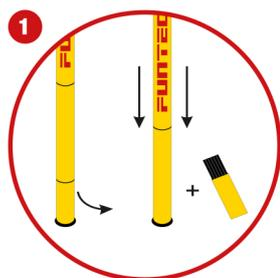
**1** Beide Netzpfeosten setzen sich aus je drei Rohren zusammen. Das Rohr mit dem FUNTEC-Schriftzug ist das Mittelteil. Das untere Rohr hat ein zusätzliches Adapterstück, das zur Verringerung der Netzhöhe entfernt werden kann.
