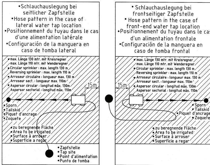
Damit der Schlauch nicht zu sehr belastet wird, sollte diese Schlauchauslegung unbedingt eingehalten werden. Zur Sicherheit ist am Mitnehmer der Seiltrommel eine Scherschraube montiert, welche bei zu hoher Zugkraft, wenn z.B. der Schlauch an einem Hindernis hängen bleibt, abschert.
