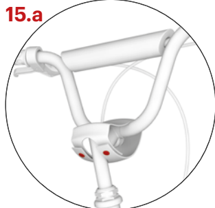
15.a Installation des éléments de protection (Two, One)
