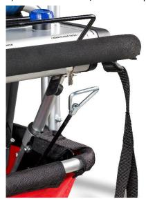
Wenn der E-Turtle Kinderbus manuell gefahren werden muss, wird der Motor mit Hilfe von dem Griff unter dem Schiebegriff auf Freilauf gestellt. Wenn man den Griff nach oben anzieht und gegen den Schiebegriff hält, kann den Wagen manuell gefahren werden. Wenn man den Griff loslässt, wird der Motor mittels einer Feder wieder angekuppelt.
