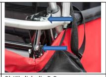
3) Jährlich die P-Bremse an beiden Seiten oben und unten schmieren.
