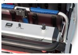
Der Zündschlüssel schaltet den Strom ein und aus: Zum Einschalten nach rechts drehen. Zum Ausschalten nach links drehen.
