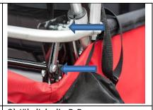
3) Jährlich die P-Bremse an beiden Seiten oben und unten schmieren.
