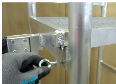
Ringschraube zum Verstellen der Podestplatte auf beiden Seiten lösen
