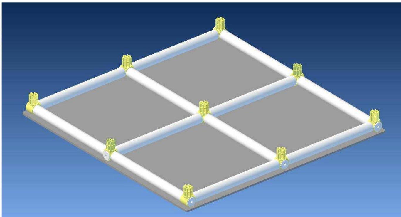
Setzen Sie die 9 Rohre C, wie in der Abbildung gezeigt, ein. Achten Sie auf die Position der Löcher, da die Schrauben in die entsprechende Nut eingesetzt werden müssen. Zum Eindrehen von selbstschneidenden Zylinderschrauben, ist ein Schraubendreher mit Kreuzschlitz.
