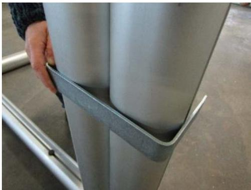
1. Zu sichernde Tore mit der Öffnung (Pfosten an Pfosten) aneinander stellen und gekanteten Bügel um die Pfosten legen.
