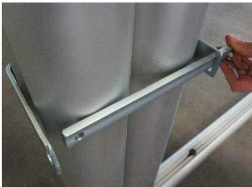
2. Riegel von einer Seite bis zum Anschlag durch die seitlichen Öffnungen im Bügel führen.
