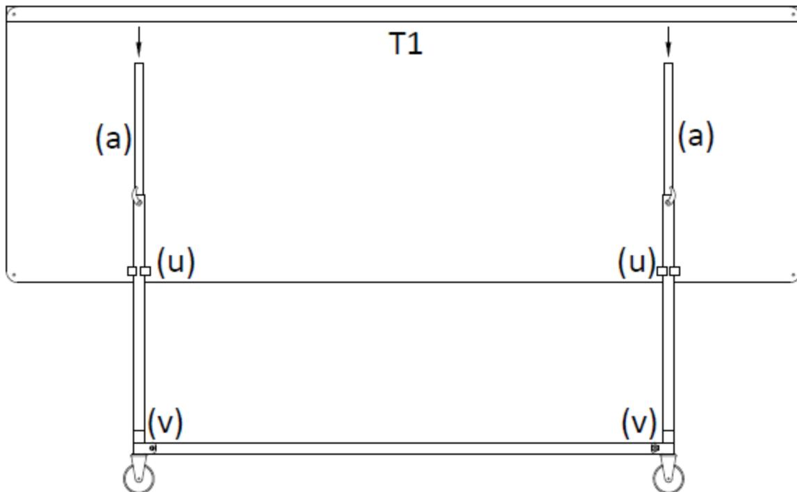
**ACHTUNG:** die Rollfüße müssen belasten oder befestigen werden um die Stabilität zu gewährleisten. Die Bremsen der Rollfüße müssen blockiert sein. In keinem Fall kann Stramatel für einen Unfall aufgrund der Instabilität der Anlage haftpflichtig sein.
