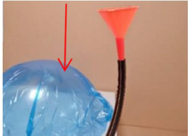
2. Zum Befüllen der Halbkugel halten Sie das Schlauchende mit aufgestecktem Trichter ca. 20 cm über dem Wasserspiegel der Halbkugel.
