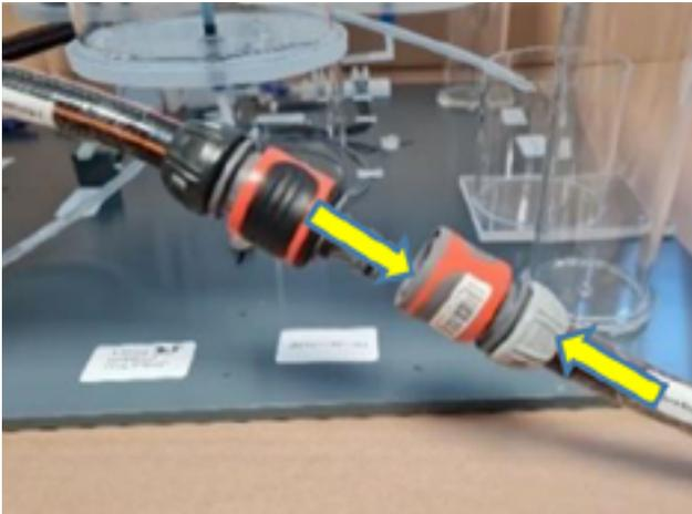
1. Verbinden Sie den mitgelieferten Schlauch mit „Gardena“ Anschlusskupplung 1 und Trichter mit der „Gardena“ Anschlusskupplung 2.
