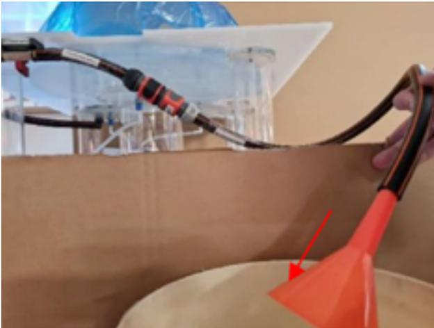
6. Nachdem der Ablasshahn wieder geschlossen ist, wird der Schlauch mit aufgesetztem Trichter seitlich neben der Halbkugel unter den Wasserspiegel in ein Auffanggefäß (Eimer) geführt. Das sich im Schlauch befindliche Restwasser kann nun ablaufen.
