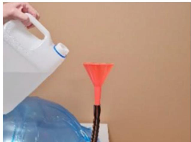
4. Füllen Sie nun das **DESTILLIERTE WASSER** über den Trichter ein.
