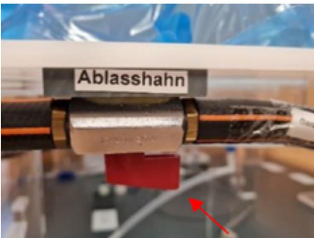
3. Öffnen Sie anschließend den Ablasshahn.
