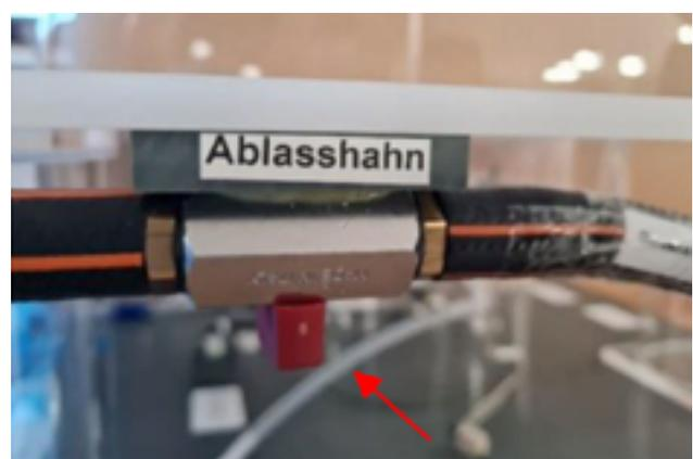
... wird der Ablasshahn wieder geschlossen. Bitte achten Sie stets darauf, dass das Schlauchende mit dem aufgesteckten Trichter immer ca. 20 cm über dem Wasserspiegel der Halbkugel gehalten wird.
