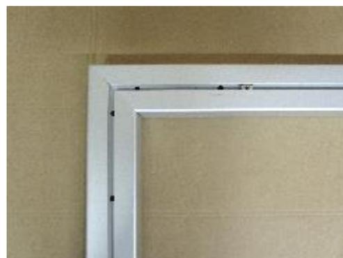
Im nächsten Montageschritt auf jede Latte/Pfosten-Ecke 1 Stck. Stahl-Winkel legen (siehe Foto unten links). Dabei die Bohrlöcher jeweils von Winkel und Latte/Pfosten deckungsgleich übereinanderlegen und die Einsteckmutter neben den Winkel schieben. Nun 2 Stck. Unterlegscheiben  $\text{\O} 8,4 \text{ mm}$ , DIN 9021 auf 2 Stck. Sechskantschrauben M8 x 50, DIN 933 stecken und in die beiden äußeren Bohrungen im Stahlwinkel lose einschrauben (siehe Foto unten rechts und Skizze).
