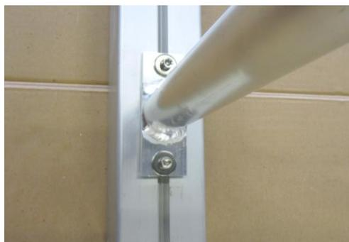
**8.1 Montage rundes Bodenrohr und Verschlusskappen:** Das runde Bodenrohr zwischen die offenen Seiten der Bodenholme legen (siehe Foto unten links). 2 Stck. Unterlegscheiben  $\varnothing$  8,4 mm DIN 933 auf 2 Stck. Sechskantschrauben M8 x 20, DIN 933 stecken und diese von der Innenseite des Bodenholms an jeder Seite in das Bodenrohr einschrauben und fest anziehen (siehe Foto unten rechts). Zur Befestigung das untere Loch im Bodenholm verwenden (siehe Foto unten links).
