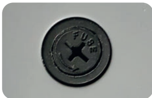
Le porte-fusible se trouve sur le dessous de l'appareil.
