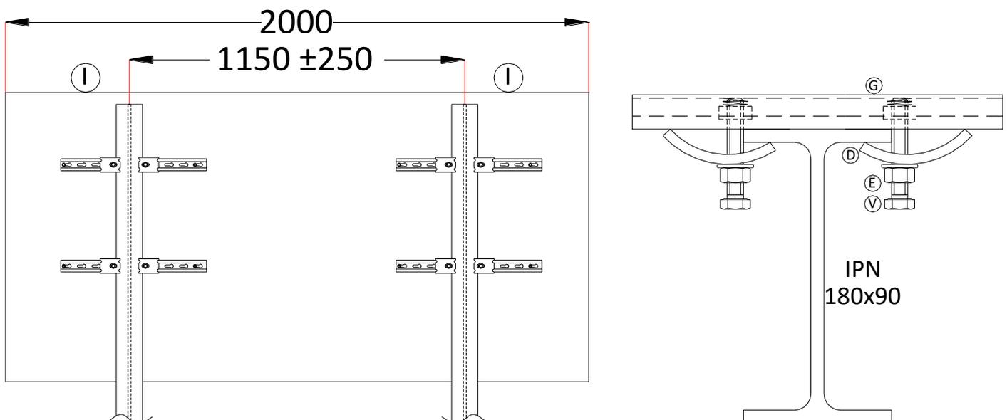
**● Montageanleitung an die Wand / an einem Gestell - Vorbereitung der Installation**
