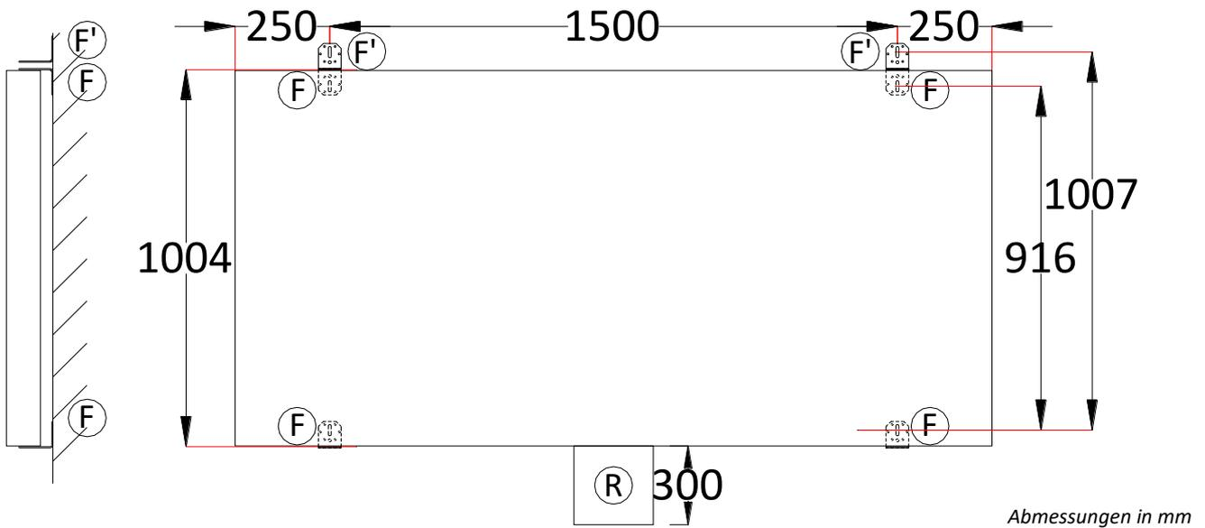
**● Montageanleitung an die Wand / an einem Gestell - Aufstellung der Anzeigetafel**
