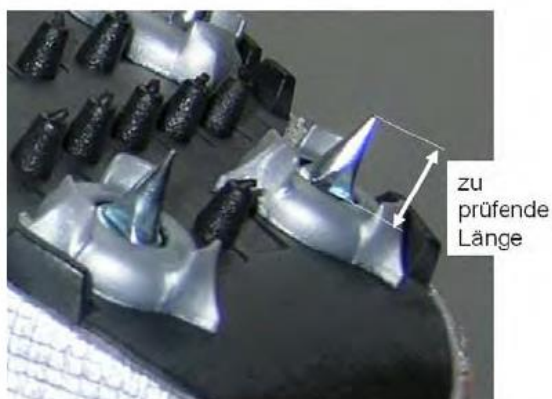
Spikes-Prüfung auf Länge und Form
