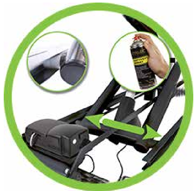
Haftschrnierfett in die untere Laufschiene
