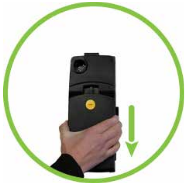
Gehäuse nach unten ziehen
