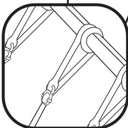
Durch mehrfach umschlingen kann die Seilhöhe verändert werden.
