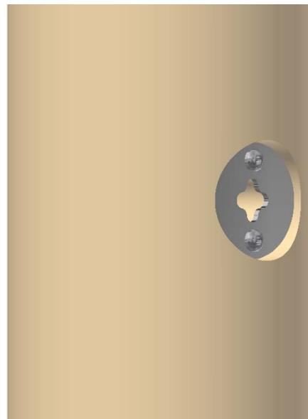
Kreuzschlitzscheibe mit beiliegenden 5,5 x 19mm Linsenkopfschrauben an der Pfosteninnenseite (Ketteneingang) befestigen.
