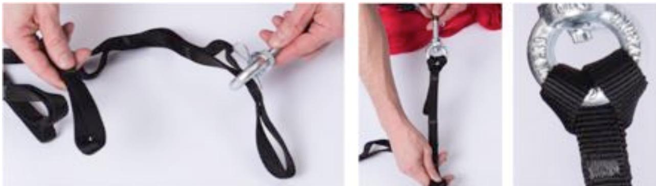
Nun kannst Du das Tuch mittels der Karabiner an der bzw. den DaisyChain(s) anhängen, indem Du die am Tuch montierte Schlaufe und die DaisyChain mit dem Karabiner verbindest.
