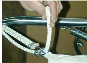
2. Gummikabel immer von links nach rechts montieren. Gummikabel von **unten** durch den Eckring führen. Danach Gummikabel durch einen Haken für die Rahmeneinhängung führen.
