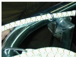
6. Gummikabel wie angezeigt durch Lochplatte führen; mit Klebeband das Ende umwickeln. Vorgang entsprechend für vier Seiten wiederholen.
