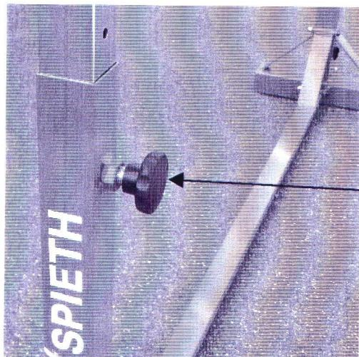
Drehen sie die Schraube etwas auf und ziehen sie das Handrad nach aussen. Der Raststift gibt das Verstellrohr frei und sie können es verschieben.
