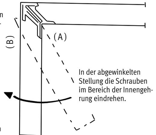
3. Oberen Netzbügel-Haltewinkel (5) auf Latte-Pfostenkonstruktion legen, Einsteckmuttern 40 mm ausrichten (genau unter die Bohrlöcher im Haltewinkel legen) und mit jeweils 4 Stück Sicherheits-Sechskantschrauben M 8x16 lose befestigen.
