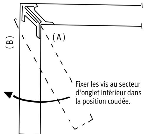
3. Poser l'angle d'appui d'étrier supérieur (5) sur barre/poteaux, ajuster les vis enfichables, longueur 40 mm (à poser exactement au-dessous des forures dans l'angle d'appui) et fixer avec 4 vis de sécurité à six pans creux M 8x16 chaque.
