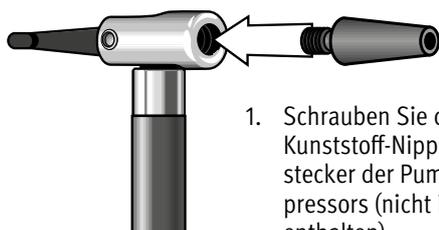
1. Schrauben Sie den konischen Kunststoff-Nippel in den Hebelstecker der Pumpe des Kompressors (nicht im Lieferumfang enthalten)
